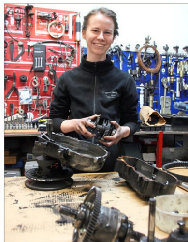
Dieses Getriebe eines Unfallers hat sie selbst zerlegt. Jetzt muss sie das kaputte Teil tauschen und wieder zusammenbauen.
